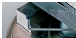
drążek nawrotnika przepływu powietrza do czyszczenia filtra
